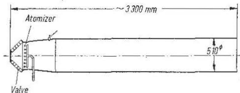
Fig. 21. 510 mm diameter Schmidtrohr
